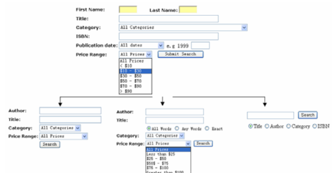
图1 Deep Web 数据集成中查询转换的实例
