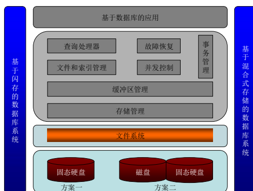
闪存数据库系统体系结构
